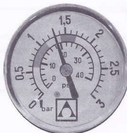
1,3 кг/см 2 - 18,5 PSI: Данное давление указывает на необходимость выполнения операции "ОБРАТНАЯ ПРОМЫВКА"
