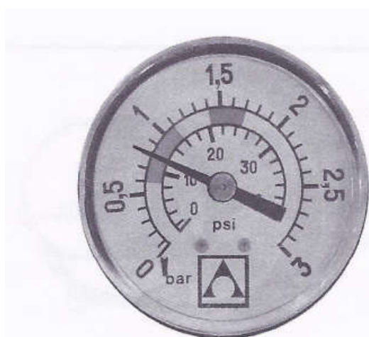
0,8 кг/см 2 - 11,4 PSI: Нормальное давление для начала фильтрационного цикла
